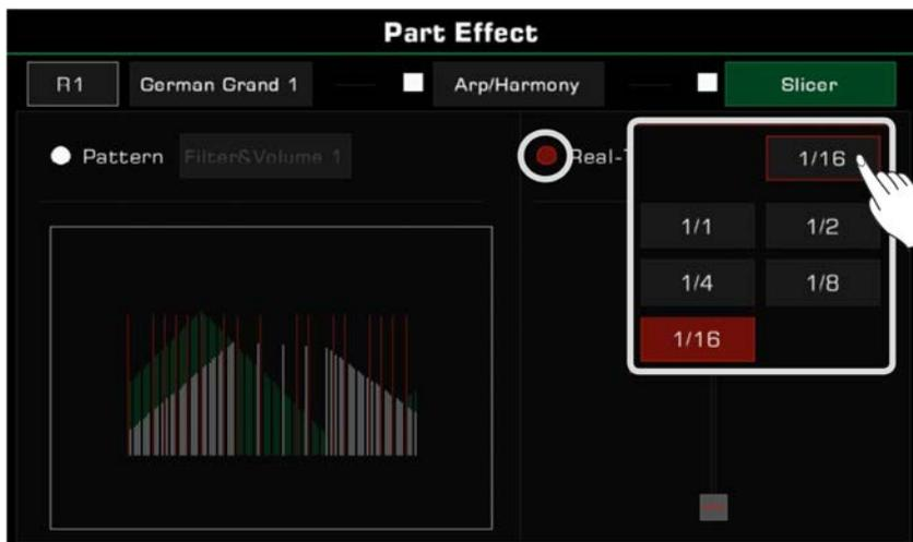
2. Drücken und ziehen Sie den Fader, um einzustellen, wie lang Sie den Sound schneiden wollen.
