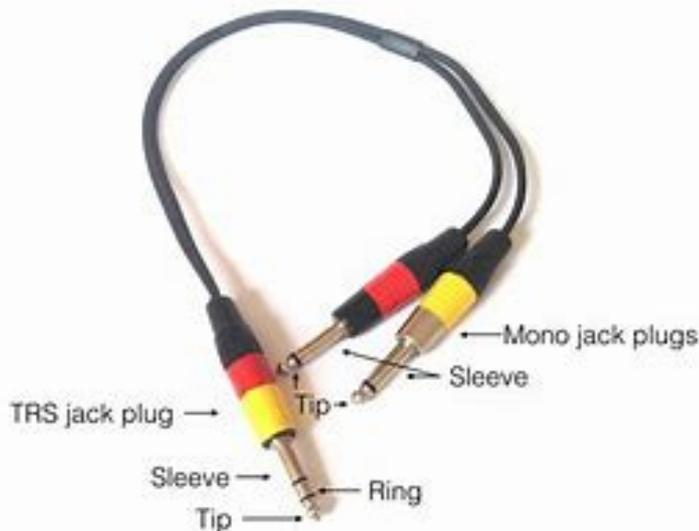
Der Stereo-Klinken Stecker wird in den AUX Out der BlackBox gesteckt, die beiden Mono-Klinken Buchsen in den Line-In des Yamaha Keyboards.
